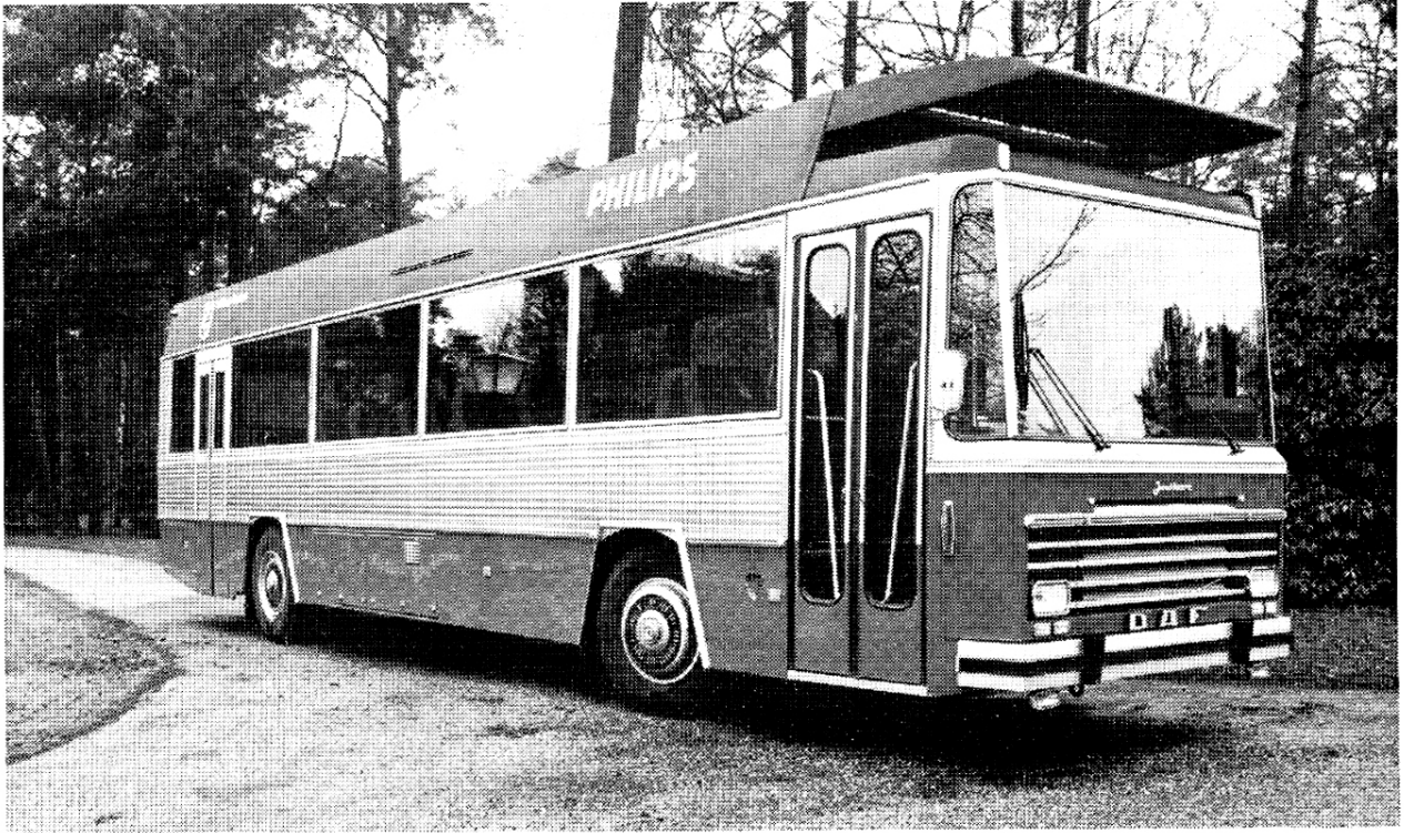
Afb. 1. De experimentele autobus met de Philips stirlingmotor.
